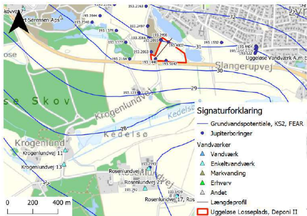
Figur 3-3 Simuleret grundvandsstand lokalt i sandmagasinet (KS2) jf. FEAR-modellen - vist med mørkeblåkurver /7/
