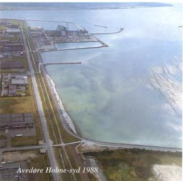
Deponeringsanlægget blev etableret i 1989 på inddæmmet land i Køge Bugt, hvilket betyder, at små mængder hav- og grundvand siver ind i deponiet. Dette vand ledes sammen med perkolatet (regnvand, som har været i kontakt med affaldet) via AV Miljøs drænsystem og pumpestationer til rensning på Avedøre
