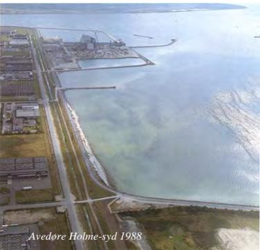
Deponeringsanlægget blev etableret i 1989 på inddæmmet land i Køge Bugt, hvilket betyder, at små mængder hav- og grundvand siver ind i deponiet. Dette vand ledes sammen med perkolatet (regnvand, som har været i kontakt med affaldet) via AV Miljøs drænsystem og pumpestationer til renstning på Biofos
